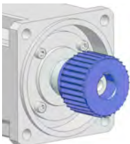
3. Zahnscheibe bis auf Kontakt mit der Distanzscheibe auf den Antriebszapfen schieben.
