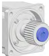
4. Scheibe in die Zahnscheibe einsetzen.
