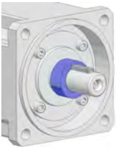
2. Distanzscheibe über die Passfeder im Antriebszapfen bis zum Kontakt zur Grundfläche aufschieben.
