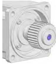
5. Scheibe mit der Zylinderschraube im Antriebszapfen verschrauben.
