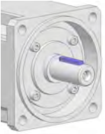
1. Passfeder in den Antriebszapfen montieren.
