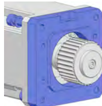
6. Adapter am Motorflansch zentrieren und verschrauben.
